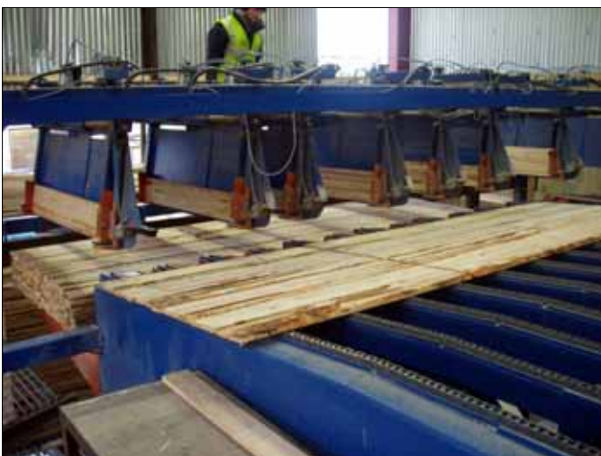
9. Empilage et pose automatique des lattes
