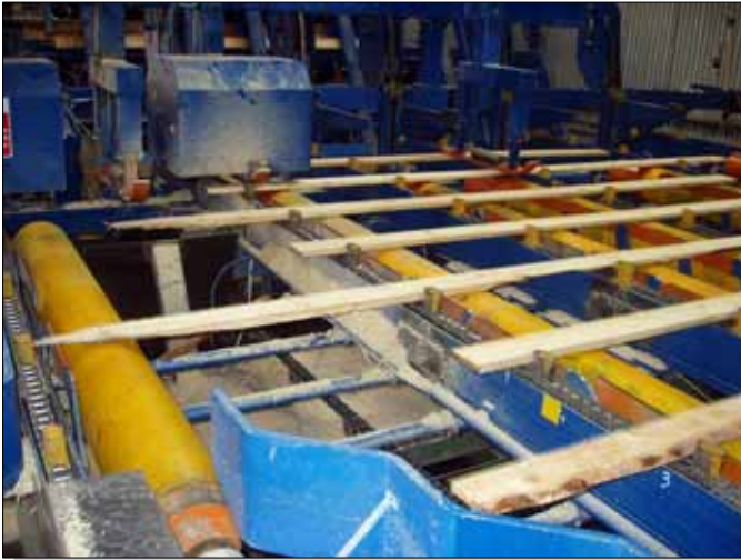
5. Eboutage et tronçonnage de déchets
