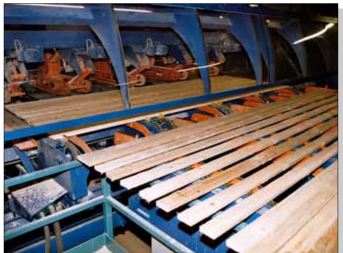
8. Ligne de tronçonnage rang par rang
