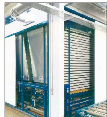
Die Hochtrockner sind wohlgeeignet für das Trocknen von Lacken mit langer Trockenzeit und hohem Gehalt von Trockensubstanz, z.B. Wasserlacken und PUR-Lacken.
