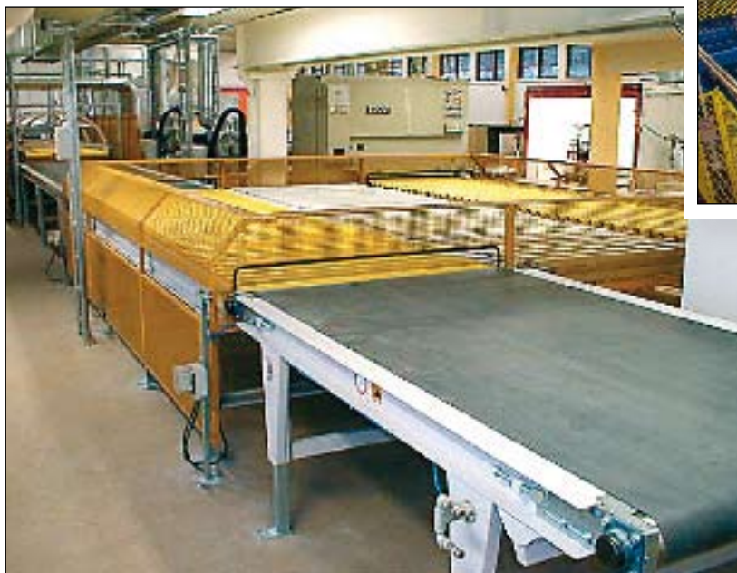
Hinabstapelung der Werkstücke mit Abstapler nach Lackierung.
