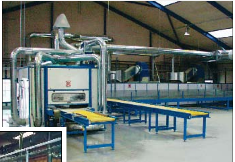
Obiges Bild zeigt eine Horizontalbahnanlage für Lackierung und Trocknen von inneren Deckenplatten.
