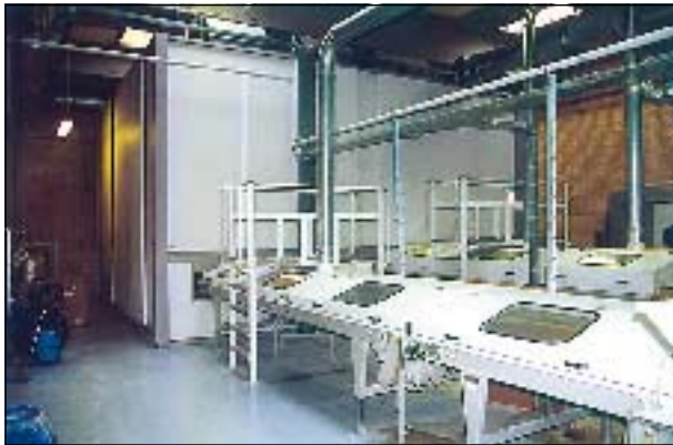
Obiges Bild zeigt eine Horizontalbahnanlage für Lackierung und Trocknen von inneren Deckenplatten.
