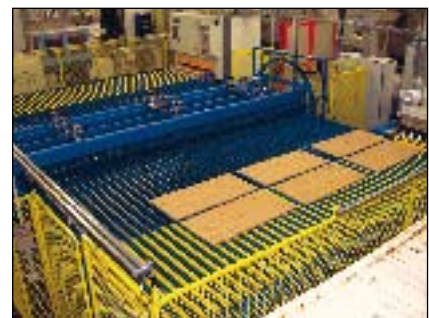
Doppelte Winkelübergabe für 180 Grad Wenden der Werkstücke, oben mit eingebautem Trommelwender.
