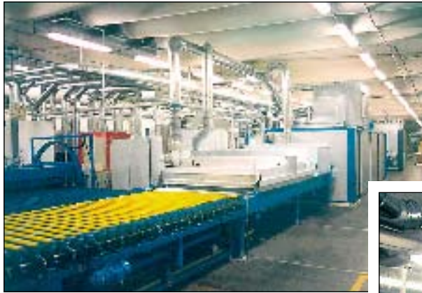
Lackieranlage für Küchenluken mit 1 Kammerofen.
