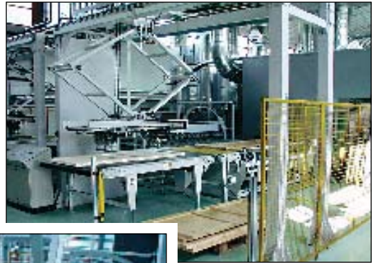
Automatischer Einleger für Werkstückeingabe in Lackieranlage.
