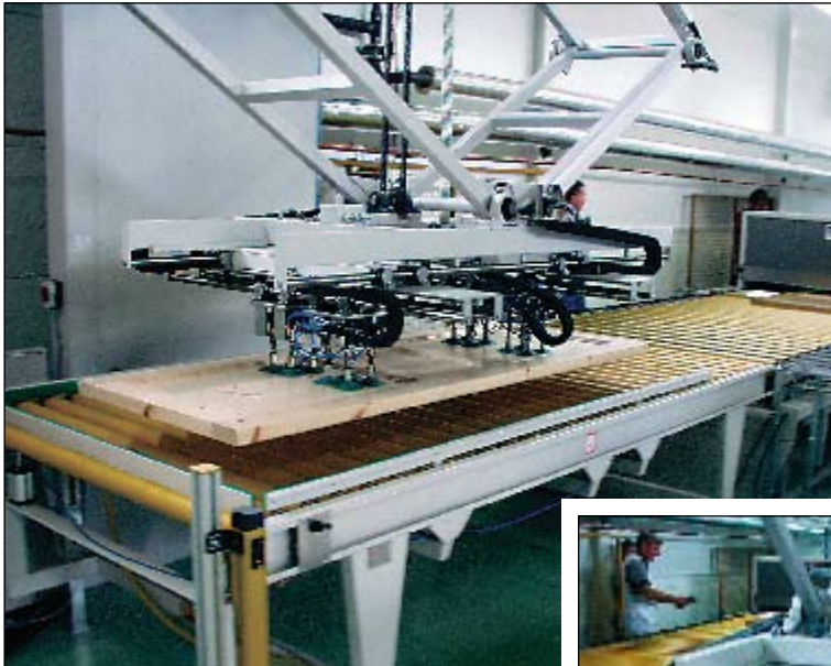
Automatischer Einleger für Werkstückeingabe in Lackieranlage.
