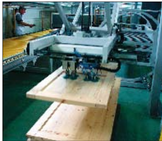
Hinabstapelung der Werkstücke mit Abstapler nach Lackierung.
