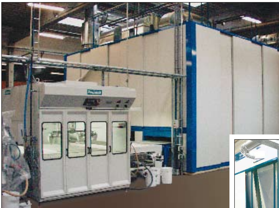
Die Hochtrockner sind wohlgeeignet für das Trocknen von Lacken mit langer Trockenzeit und hohem Gehalt von Trockensubstanz, z.B. Wasserlacken und PUR-Lacken.
