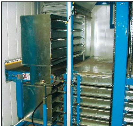
Kammerofen mit 6 Etagen aufgebaut, welches Anlagenplatz spart, so daß die Linien kürzer werden. Erhältlich als Flash-off und Trockenofen.
